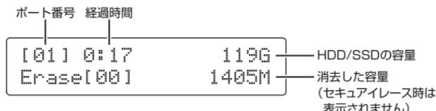
④消去が完了すると、次の画面が表示され、消去が完了したポートの黄色LEDが消灯します。
