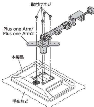
※不適切な取付けネジを使うとモニター背面を損傷したり、使用中にモニターが落下してしまうなど非常に危険です。
