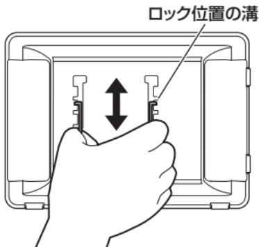
内側に押さえたまま上下に動かし、ロック位置の溝に合わせて手を離します。
