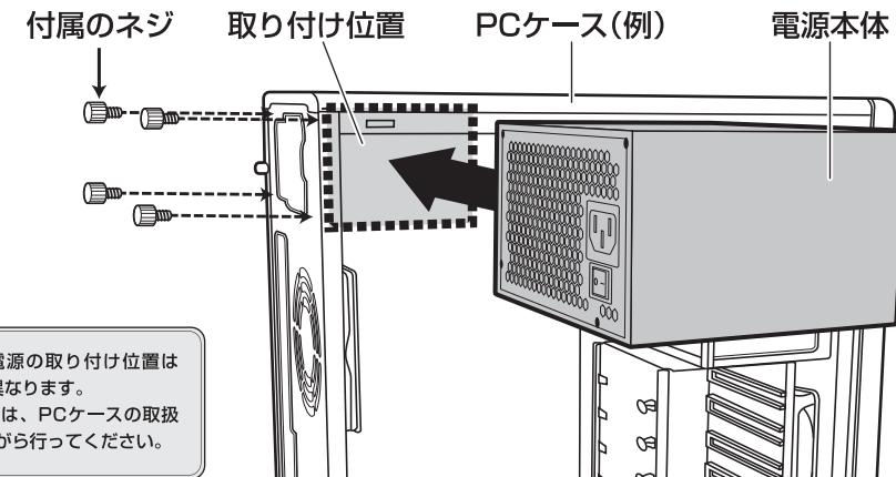
図は一例です。電源の取り付け位置はPCケースにより異なります。
